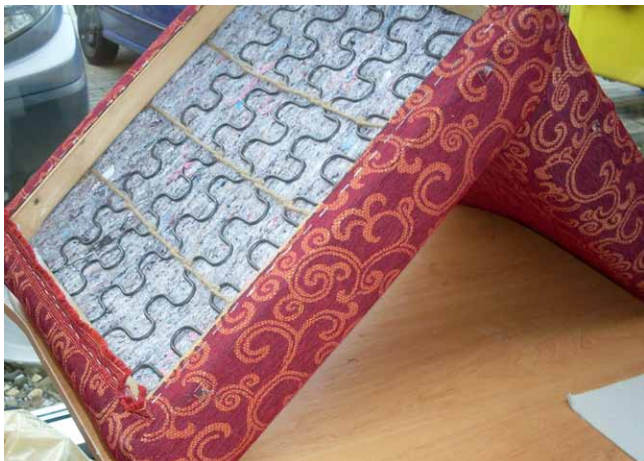
Pružný rošt sedadla z vlnitých pružin propojených vázacím motouzem
